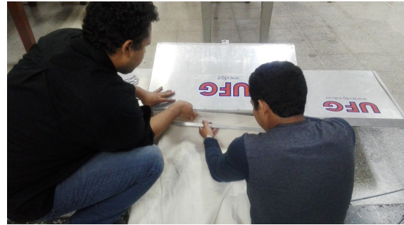
Figura 5. Adaptación de lona a Manta Trawl para mejorar la malla de la versión anterior, con el objetivo de evitar que las micropartículas de plástico escapen antes de llegar al filtro.
