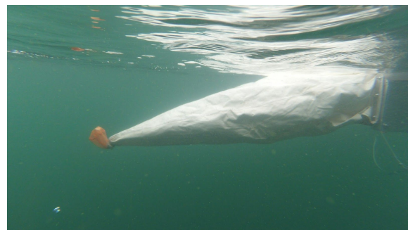
Figura 6. Imagen del Manta Trawl bajo la superficie del agua, puede apreciarse el filtro de 40 \mu\text{m} . El filtro atrapa las partículas mayores al tamaño de su malla.
