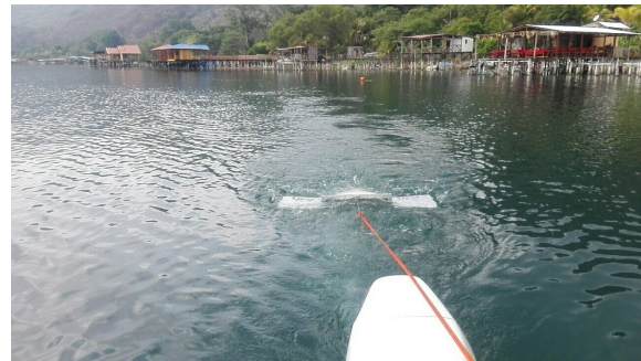
Figura 3. Imagen del Manta Trawl de la Universidad Francisco Gavidia, utilizado para la captura de partículas mayores a 40 micrones, la imagen muestra su funcionamiento en el Lago de Coatepeque. El dispositivo es arrastrado sobre la superficie del lago a una velocidad de 1.03 m/s (2 nudos) en condiciones climáticas favorables.
