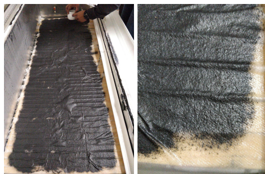
Figura 1: a) Destilador solar, prototipo #1 b) Cámara de destilación con cama flotante c) y d) flotador con material ígneo
