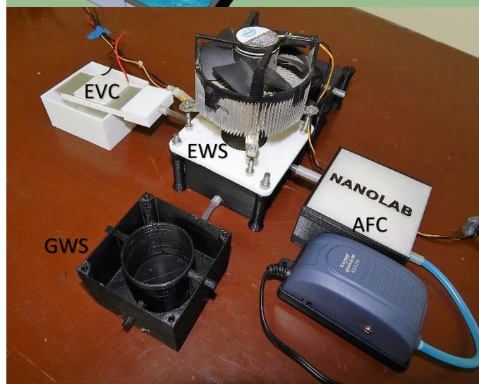
Figura 7. Prototipo experimental para realizar estudios de desalinización de aguas marinas con energía solar. Se estudia la posibilidad de patentar los subsistemas AFC, EWS y EVC. Arriba: modelo CAD del prototipo, Abajo: prototipo impreso junto con los demás dispositivos descritos anteriormente.
