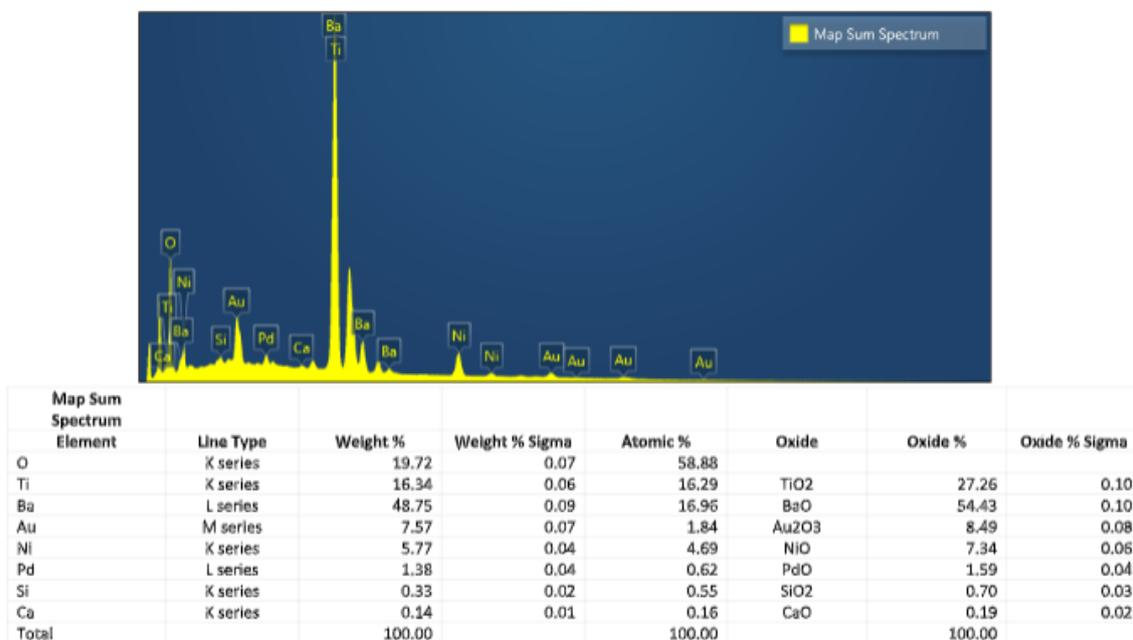
Figura 7. Lectura cuantitativa de los elementos encontrados por la lectura del EDX. En la tabla se muestra cada elemento químico detectado, el porcentaje peso que representa cada uno y de que nivel de energía fue obtenido. Además de porcentaje atómico y su respectivo margen de error (sigma).
